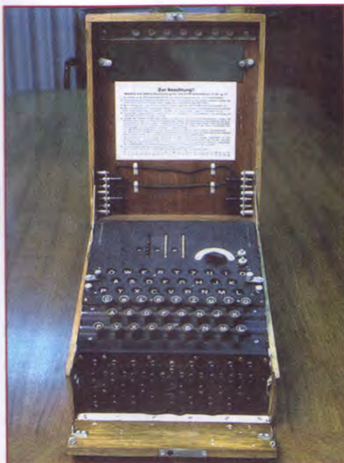
Роторная шифровальная машина Энигма, разные модификации которой использовались германскими войсками с конца 1920-х годов до конца Второй мировой войны
