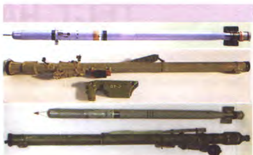
Вверху ракета ПЗРК «Игла», её пусковая труба и рукоять управления. Внизу элементы ПЗРК «Игла-1» — ракета и пусковая труба
